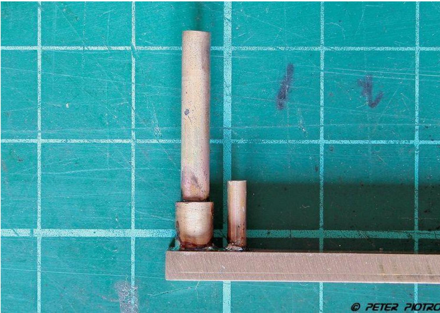
[Hier sind die Röhrchen zu einem Verstellhebel miteinander verlötet der jetzt abgetrennt werden kann]
