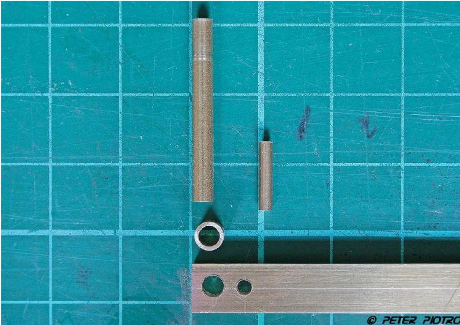
[Hier liegen die einzelnen Messingteile die dann verlötet werden müssen, der Löchabstand der beiden Bohrungen beträgt 6mm (links 3mm, rechts 2mm)]
