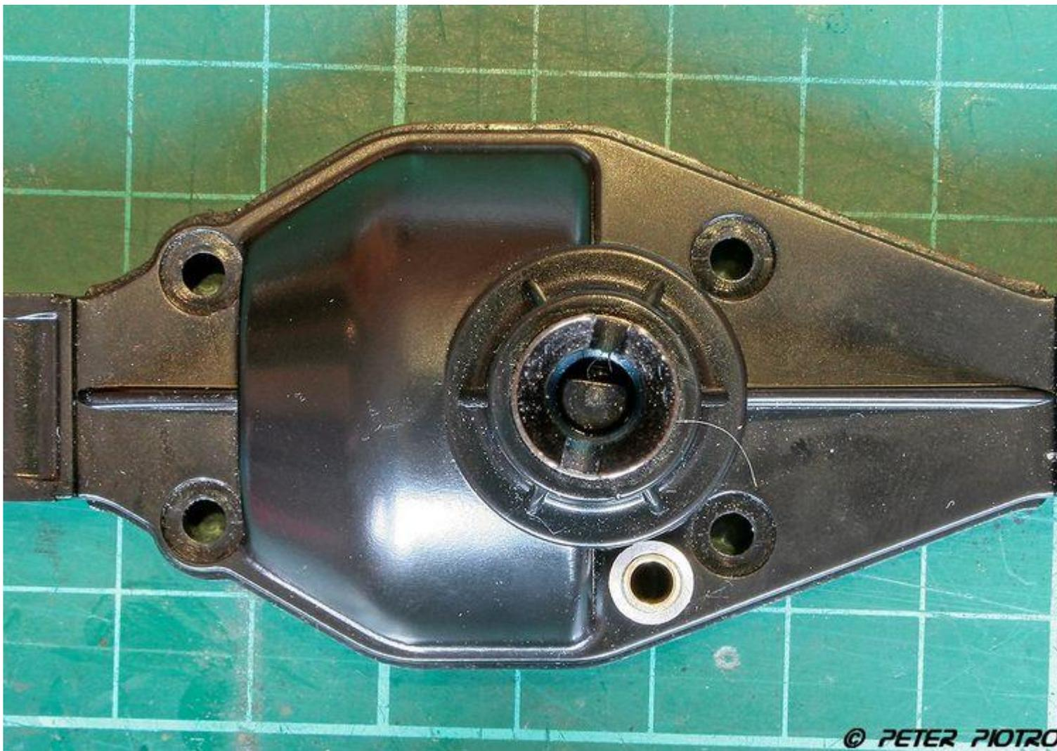
[Das Diffferenzialgehäuse außen mit der festgeklebten Durchführung]
