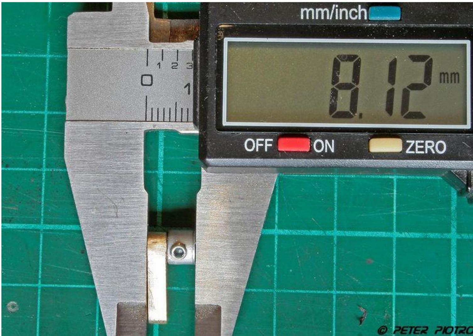
[Der äußere Verstellhebel mit dem später das Differenzial mittels Servo geschaltet wird wurde aus 4 Kantmessing, 4mm Messingrohr und 6mm Alurohr gefertigt]
