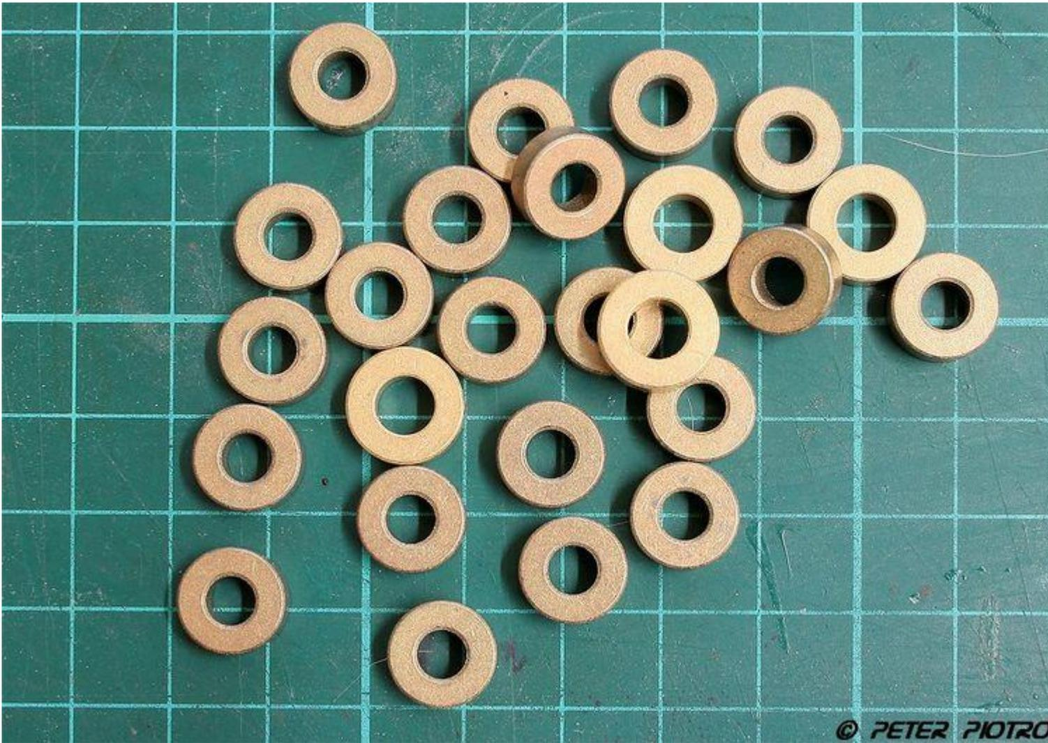
[Das sind die Bronzesinterlager die für die Herstellung der Klauenkupplung benötigt werden ]
