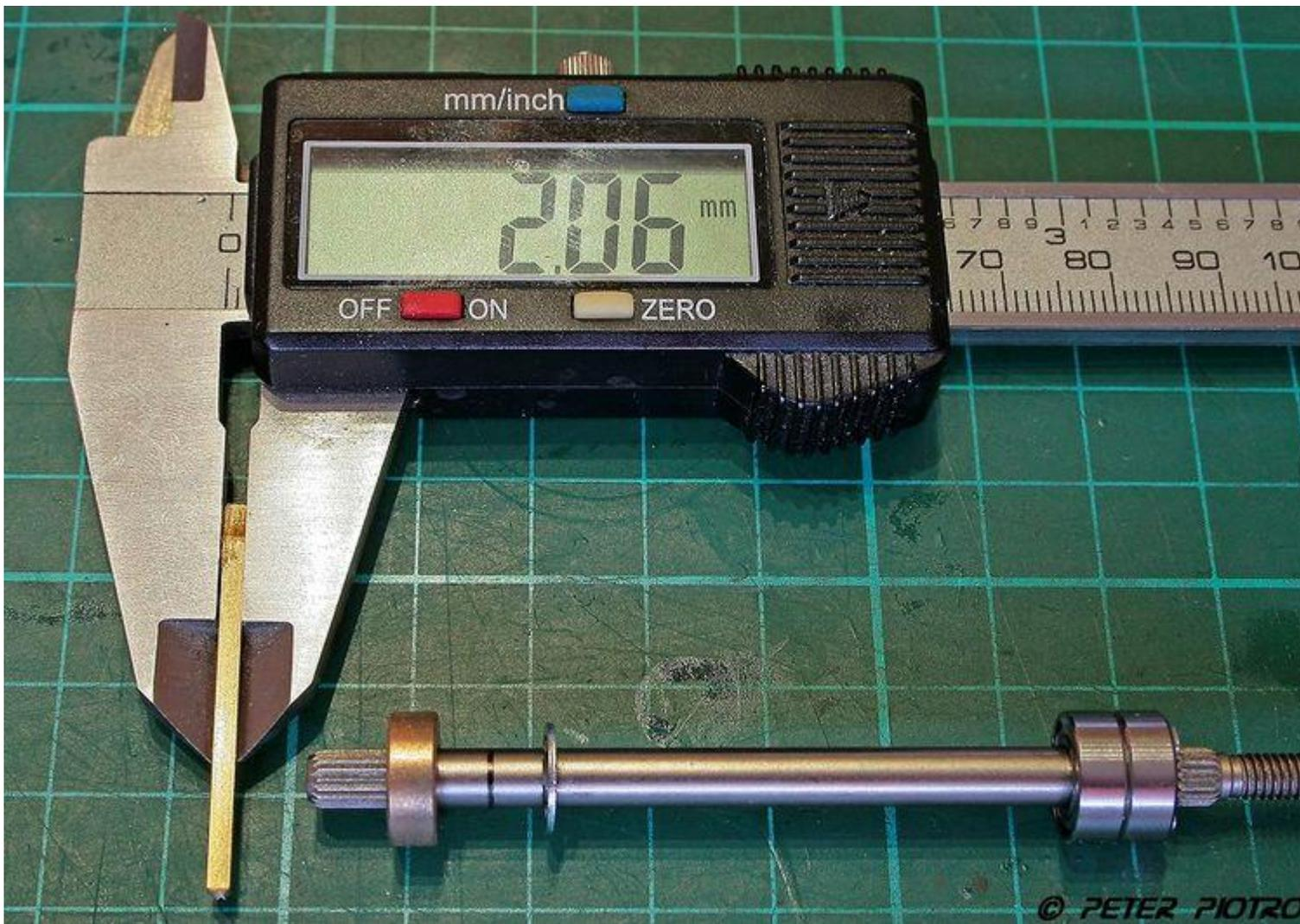
[Aus den 2mm x 2mm Vierkantmessing wird der Einlegekeil gefertigt]
