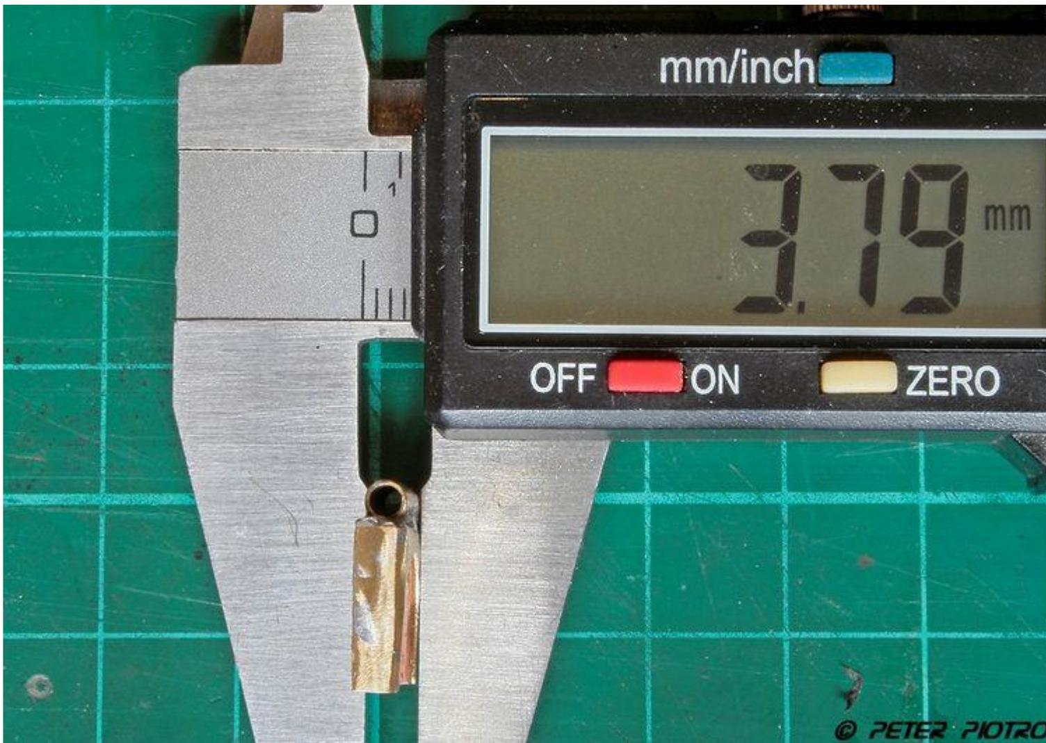
[An der Führung wurde ein 3mm Messingrohr angelötet, gut zu erkennen ist wie hoch die Flanken der Führung sind]
