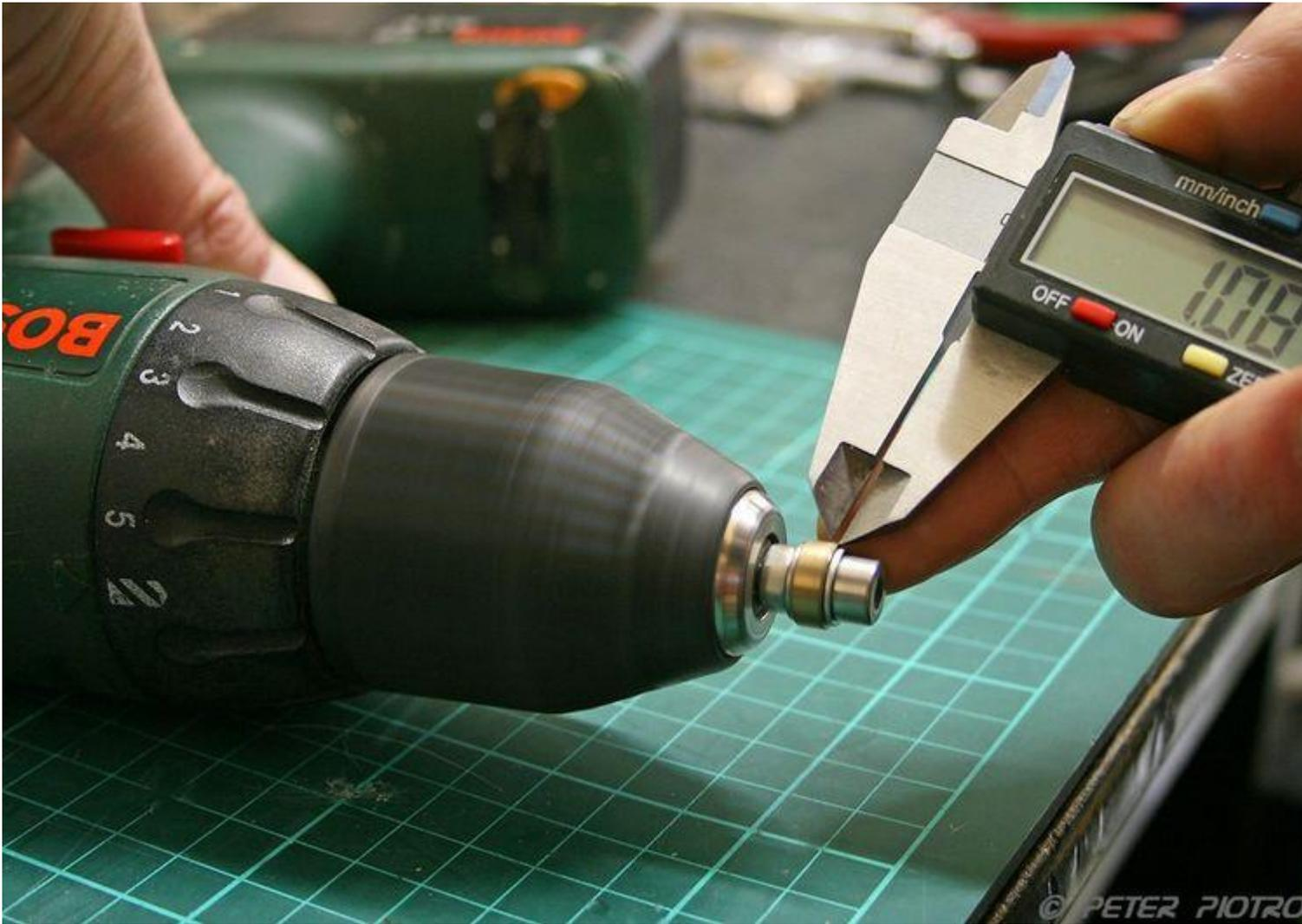
[Mit dem rotierenden Akkuschauber wird die Markierung auf das Lager gekratzt]
